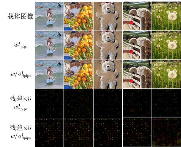
图 6 有/没有LPIPS损失引导的水印图像及水印残差
